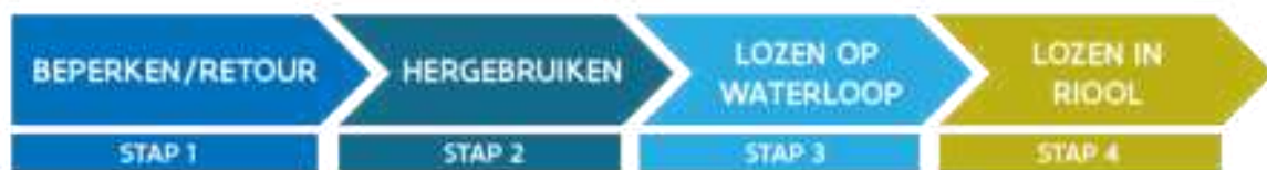
Figuur 6. Richtlijnen met de te doorlopen stappen bij bemaling van grondwater (VMM, 2023a).
