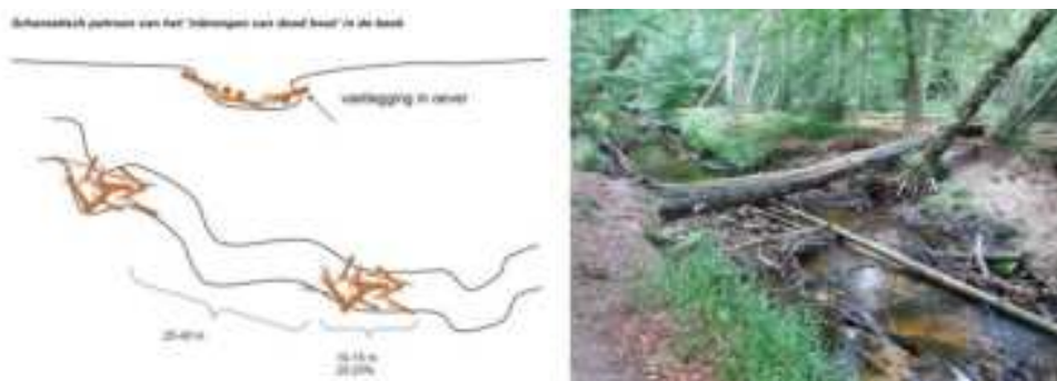
Figuur 26 Schema en voorbeeld aanbrengen dood hout (bron: Beekdalbreed hermeanderen, STOWA 2012-36)
