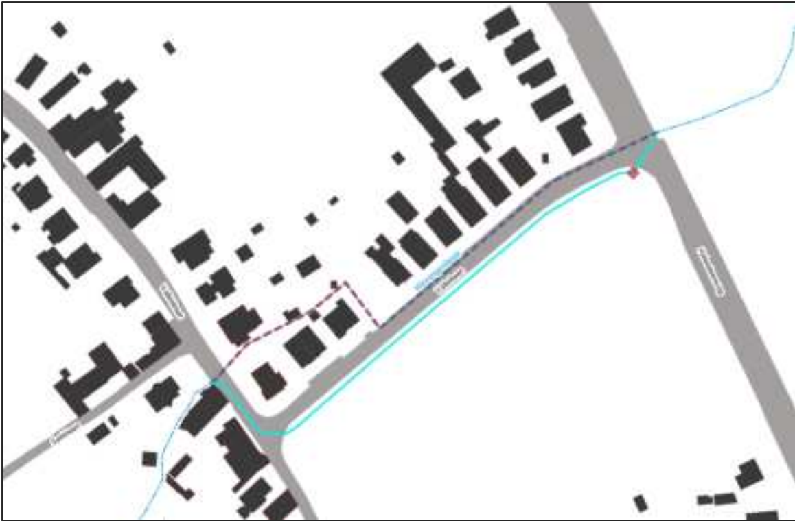
Figuur 45 Inbuizing (rode stippellijn) vervangen door open buffergrachtgracht langsheen valleibaan
