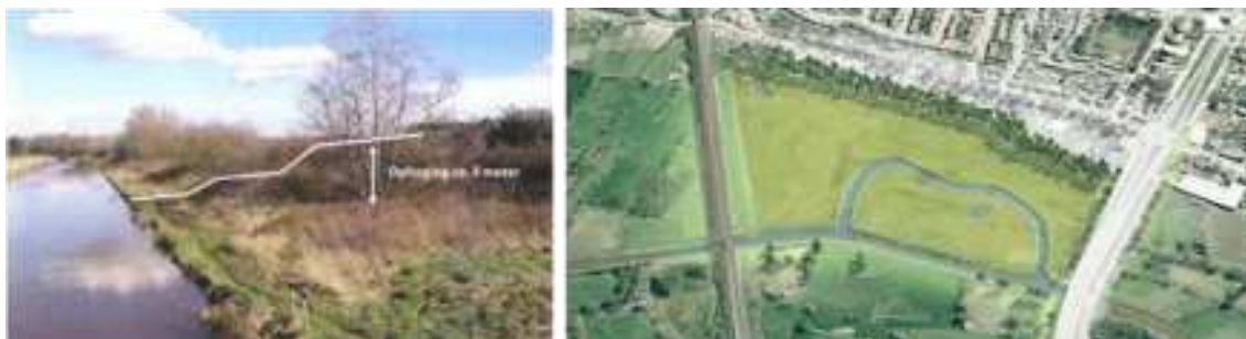
Figuur 29 Herinrichting 'Hellekens' te Herentals dmw afgraven talud (bron: www.vmm.be )
