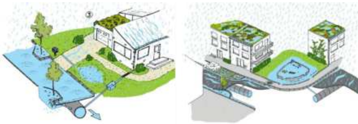
Figuur 13 Extreme neerslagafvoer: gecontroleerd overstroomen © Aquafin.
