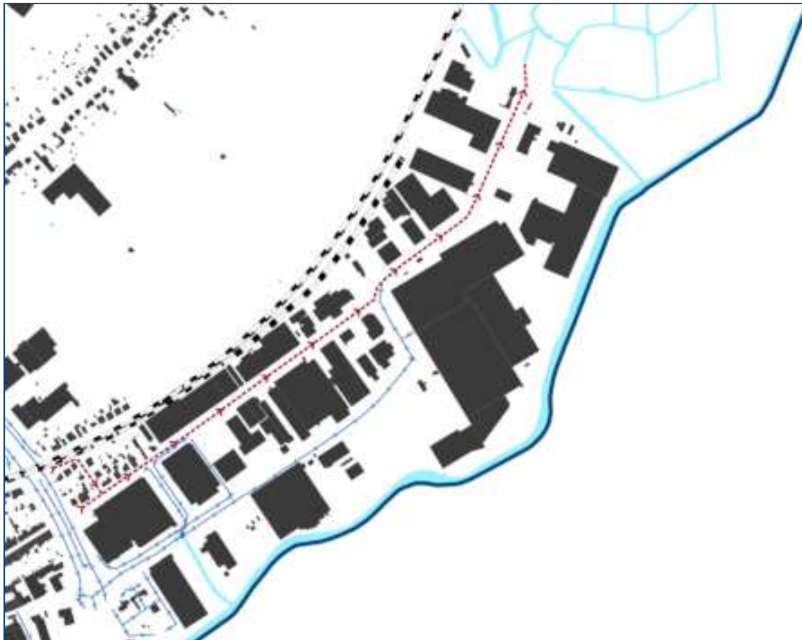
Figuur 5: voorstel tracé RWA afvoer
