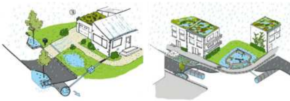
Figuur 12 Opvang en vertraagd afvoeren van hemelwater bij een norm neerslagafvoer © Aquafin.
