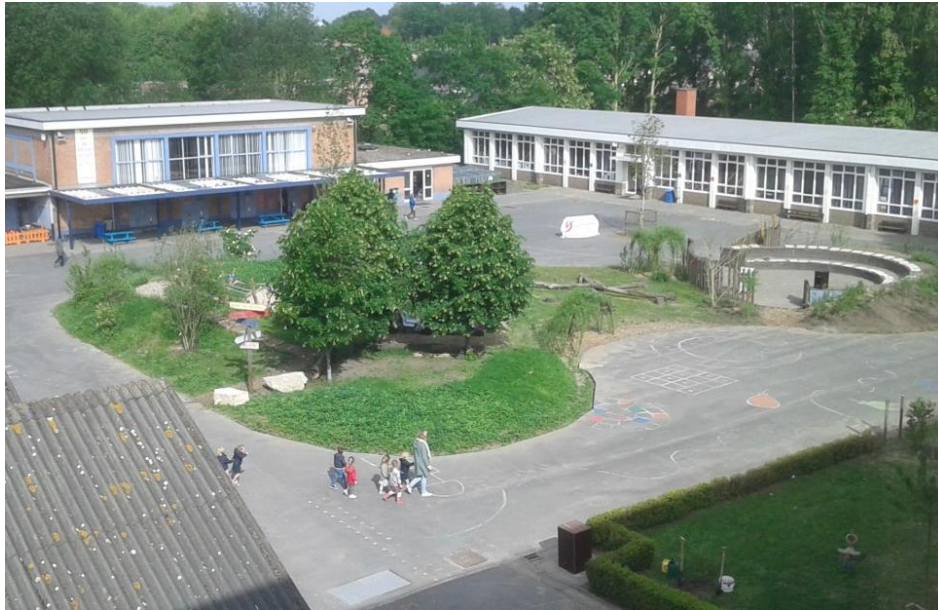
Herinrichting volledig geplaveide speelplaats tot klimaatgezonde speelplaats in een school in Eeklo, het zitgedeelte rechts fungeert tevens als opvang van water bij hevige regenval, bomen zorgen voor verkoeling.
